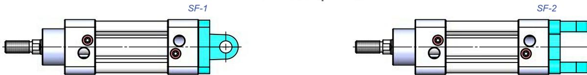
**SFWCFM Монтаж при помощи фланца с осью и опорной стойки**
